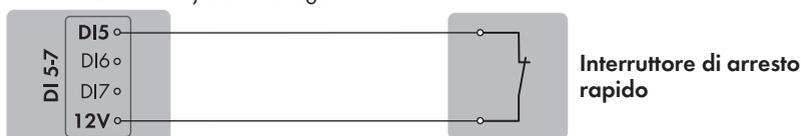
Figura 12: Connessione di un interruttore per l'arresto rapido all'ingresso digitale DI 5 del Sunny Tripower che deve essere configurato come System Manager
